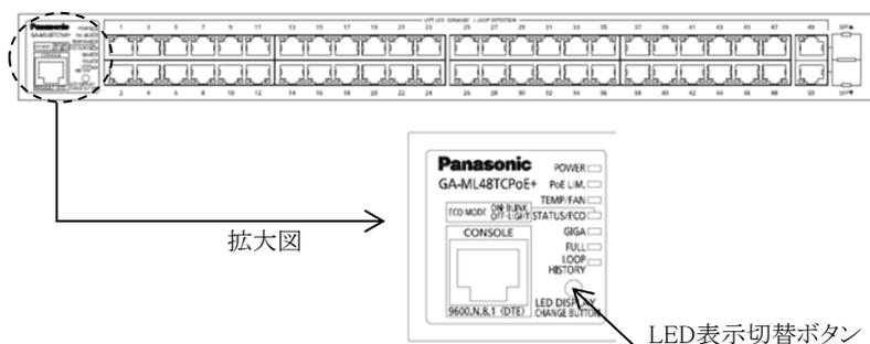
2種類のベースモードと各モードのLEDは以下のように切替えができます。
